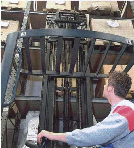
Optimale Durchsicht durch das Fahrerschutzdach durch modifizierte Strebenanordnung und -winkelung
