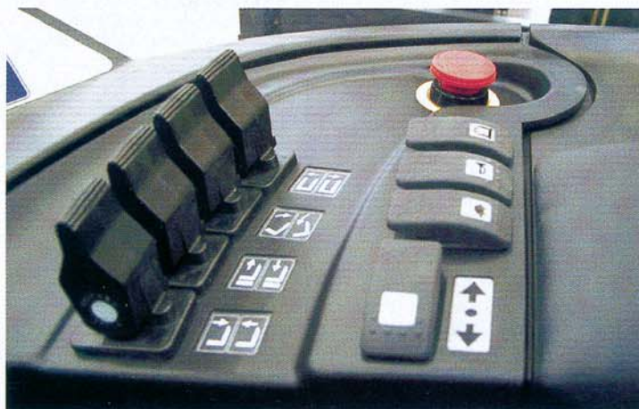
Vier-Hebel-System für überlagerte Steuerung beim Heben, Senken, Schieben, Neigen und beim Querschub
