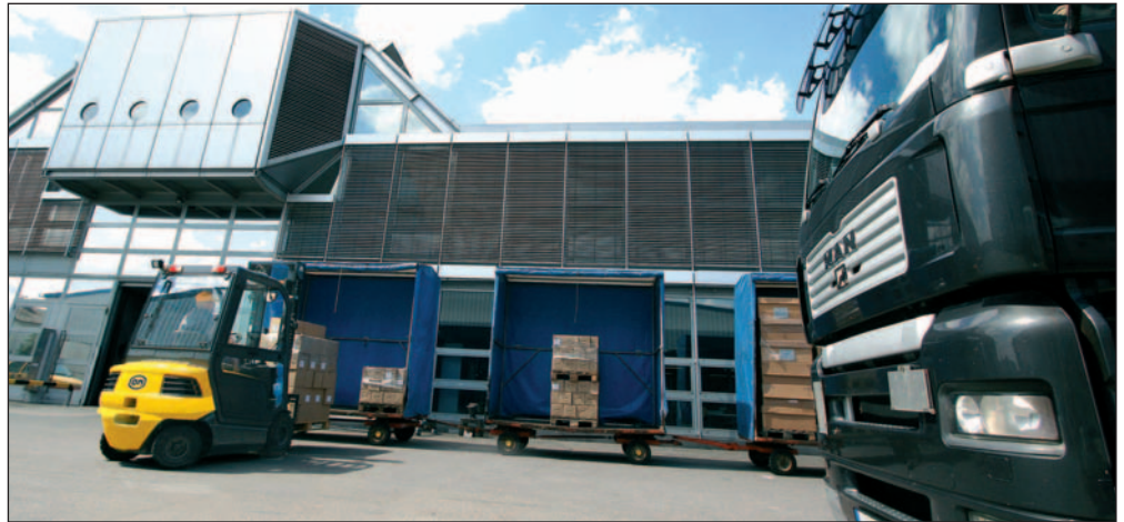
Elektryczny wózek XE25ac załaduje wagoniki i ciągnie je z prędkością 20 km/h na odcinku ekspresowym na terenie zakładu.
