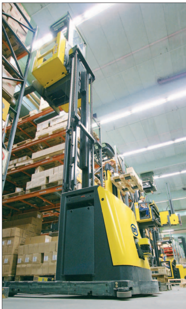
5 elektrycznych, konsygnacyjnych wózków wysokiego podnoszenia XOP2 w wersji „man-up” jest wyposażonych w dodatkowy podnośnik w celu wygodnego podnoszenia.
