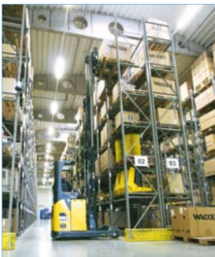
Wózek podnośnikowy z wysuwającym masztem XRac z możliwością kierowania bez ograniczeń - 360°, podnosi palety na najwyższą płaszczyznę regałów w magazynie części zamiennych.
