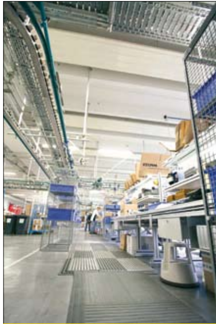
Dziennie wykorzystywanych jest 800 wózków wiszących prowadzonych na szynach, służących do odprawy sprawdzanych towarów.
