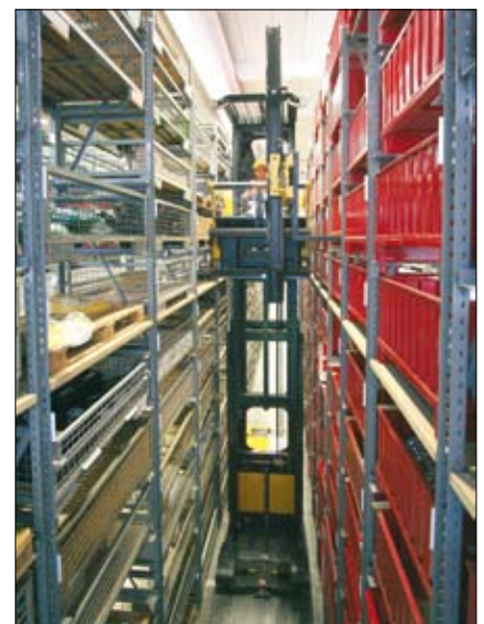
Sterowany indukcyjnie XNAAc, skonfigurowany do zadań specjalnych. Widły znajdują się na wysokości oczu operatora.
