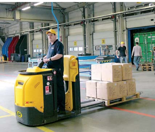
Горизонтальный сборщик заказов XLOGOас может перевозить две паллеты одновременно благодаря длинным вилам.
