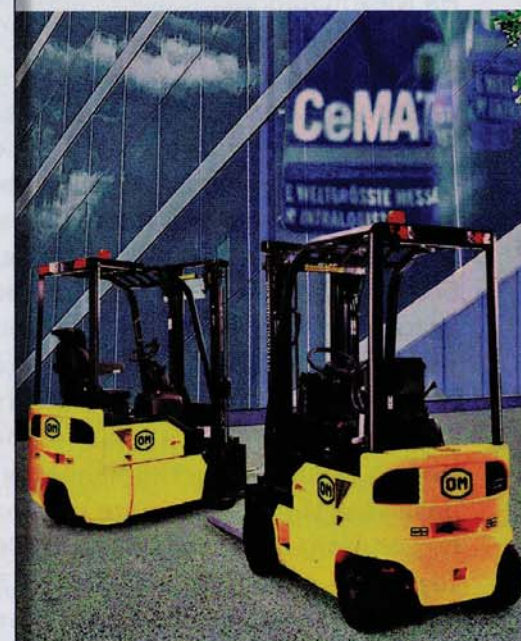
В новый конструктивный ряд электропогрузчиков OM входят трех- или четырехопорные модели грузоподъемностью от 1,3 до 2 т
