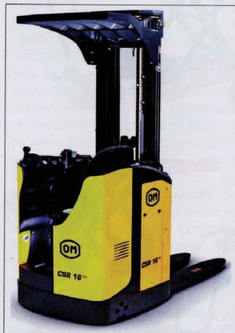
Высокоподъемный штабелер CSRac с сиденьем оператора оснащен электродвигателем переменного тока
