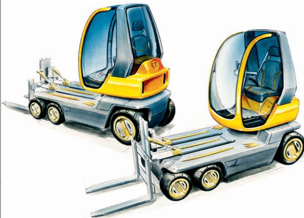
Таким в недалёком будущем видит дизайн-студия «Zagato» вилочный погрузчик OM с поворотной кабиной (проект JANUS)
