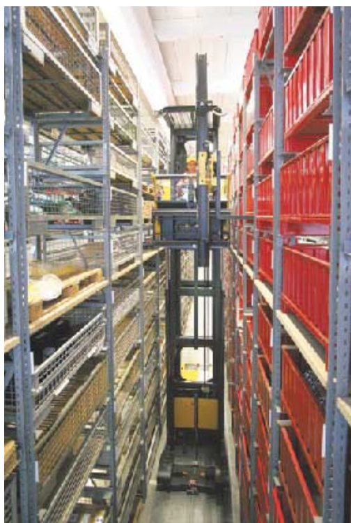
Кабина узкопроходного штабелёра XNA ac поднимается вместе с вилами
