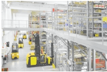
Der Flotteneinsatz von XE und XNAac Elektrostaplern sichert den Teilefluss im HRL.
