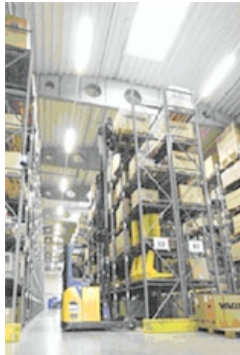
Der XRac Schubmaststapler hebt die Paletten in die oberste Regalebene
