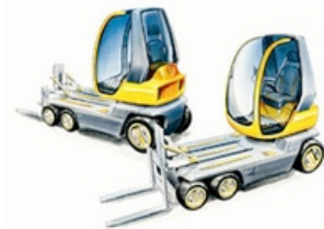
Zagato-Designstudie JANUS mit Drehkabine als OM-Stapler der Zukunft
