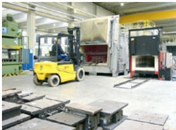
Der OM Schwerlaststapler XE 35 beim Handling der tonnenschweren Stanz- und Presswerkzeuge an der 600 °C Ofenanlage.
